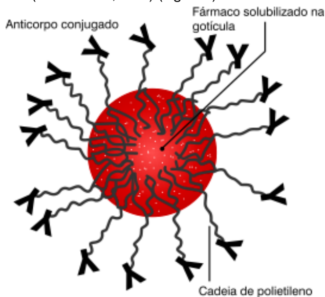
Figura 1. Emulsão contendo anticorpos ligados covalentemente à superfície e fármaco solubilizado nas gotículas da fase interna.
