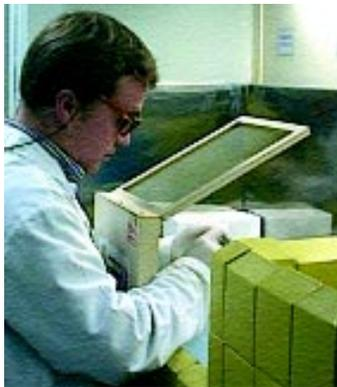
Marcação do fármaco com o elemento radioativo sob blindagem de proteção para o operador
