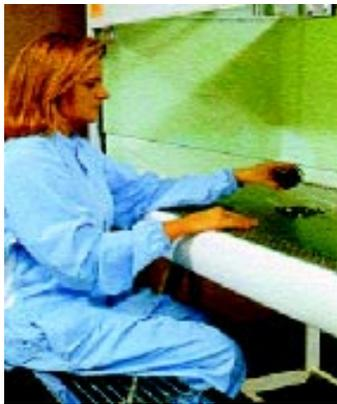
A capela de fluxo laminar serve para a produção de conjuntos de reativos para marcação futura, bem como para a marcação de elementos figurados do sangue com  $^{99m}\text{Tc}$
