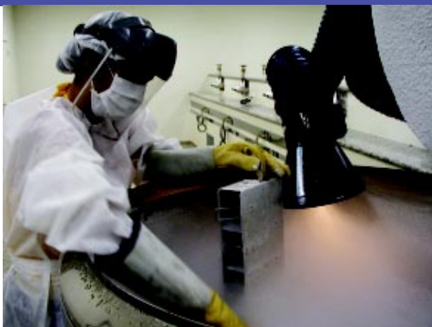
A farmacêutica-bioquímica Sílvia Azevedo abre tanque de nitrogênio líquido, onde estão armazenadas células-tronco a uma temperatura de -200^{\circ}
